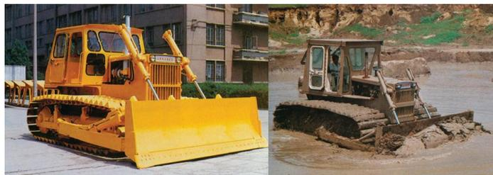
1984年，山推TS220型湿地推土机完成试制；1986年，山推TSC140A型潮湿推土机完成试制
