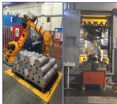
汽车轮毂自动化生产线
