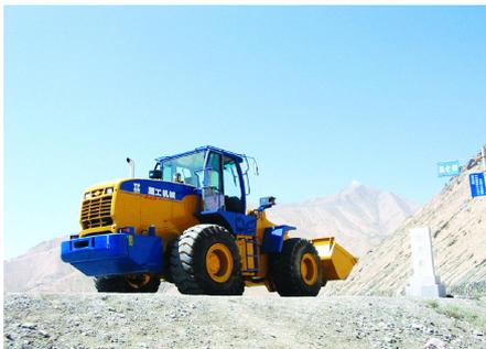
厦工装载机在进行高远适应性实验
