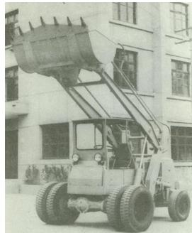
1965年9月，成工与一机部建筑机械研究所联合测绘日本SD20装载机，命名为Z4-2型轮式装载机
