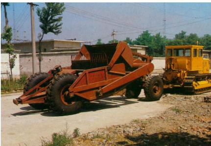
1963年8月郑州工程机械厂完成CL7型自行式铲运机的设计，1966年6月装成样机，1975年6月赴联邦德国展出的CL7自行式铲运机。
