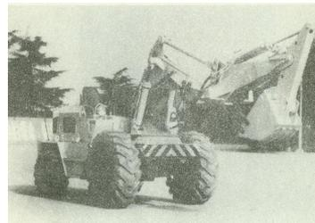
1967年成工与天工所联合测绘西德A68回转式装载机，试制后命名Z4H2回转式装载机
